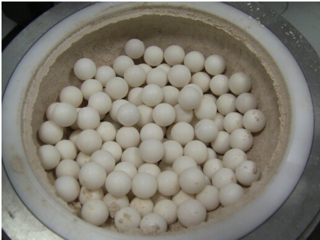
Bild 7: Probe 2; Verbacken nach weiteren 5 Min. mit 150 U/Min.
