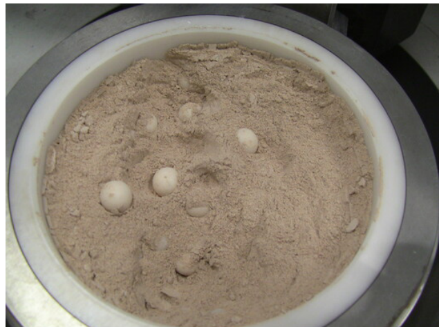
Bild 4: Probe 2 nach 2 Min. mit 450 U/Min.
