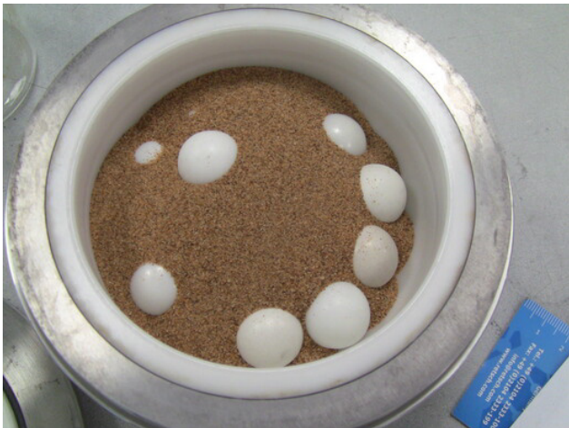
Bild 9: Vorzerkleinerung für Nassvermahlung: 250 ml Mahlbecher aus ZrO 2 + 15x 20 mm Kugeln
