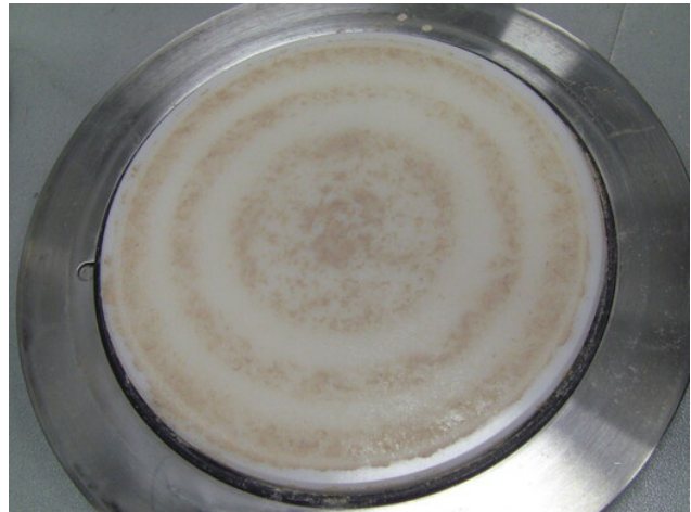
Bild 8: Probe 2; Verbacken nach weiteren 5 Min. mit 150 U/Min.
