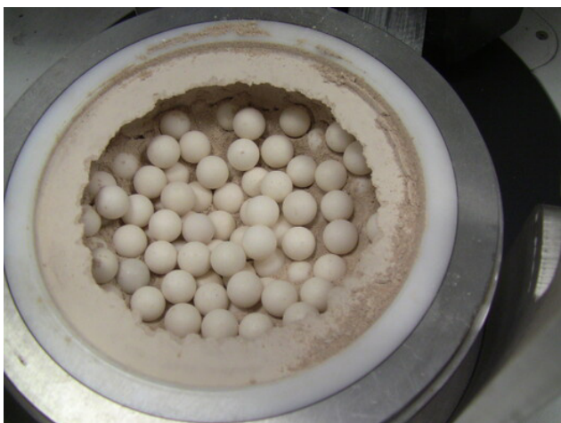
Bild 5: Probe 2; Anbackungen nach weiteren 5 Min. mit 200 U/Min.
