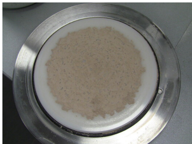
Bild 6: Probe 2; Anbackungen nach weiteren 5 Min. mit 200 U/Min.
