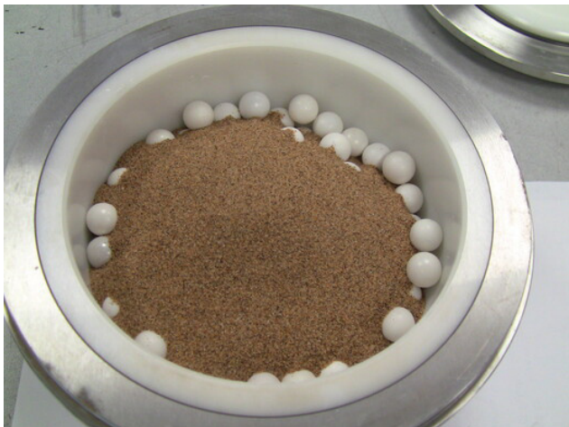
Bild 3: Trockenvermahlung: 250 ml Mahlbecher aus ZrO 2 + 120x 10 mm Kugeln
